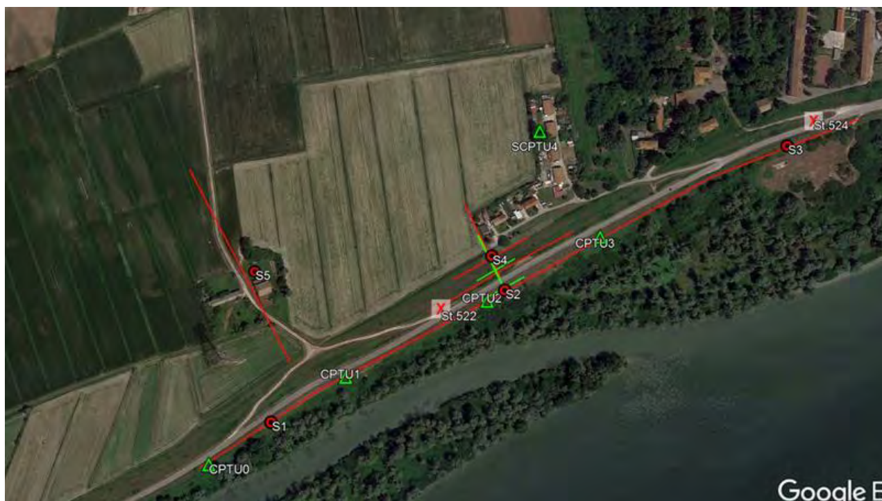
Figura 11 - Planimetria con ubicazione dei punti d'indagini geognostica in località Cavanella Po
